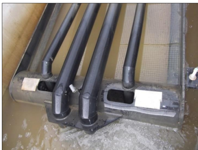
Sifón (izquierda) y contador de pulsos (derecha)
