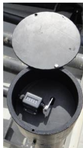
Sifón (izquierda) y contador de pulsos (derecha)
